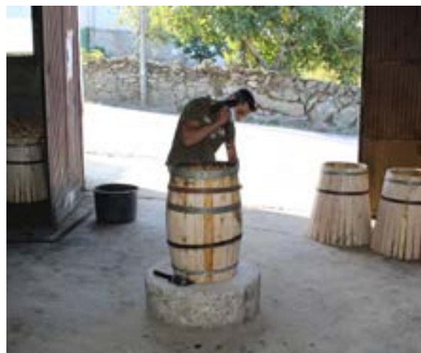
Fig. 17 Colocação dos arcos provisórios na mó e amassar o barril
