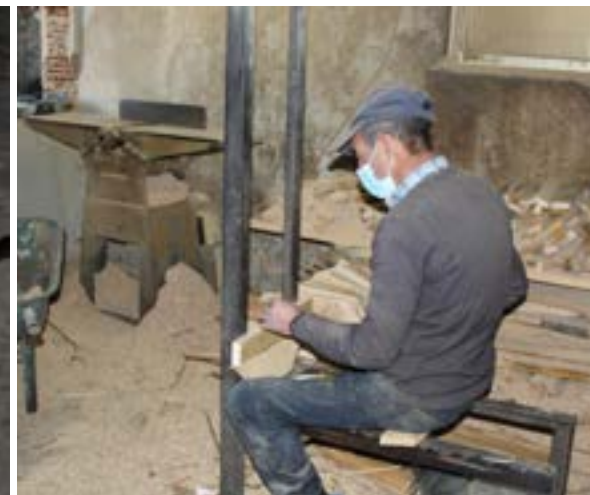
Fig. 24 Encavalitar os fundos com prego de dupla ponta e palha tábua
