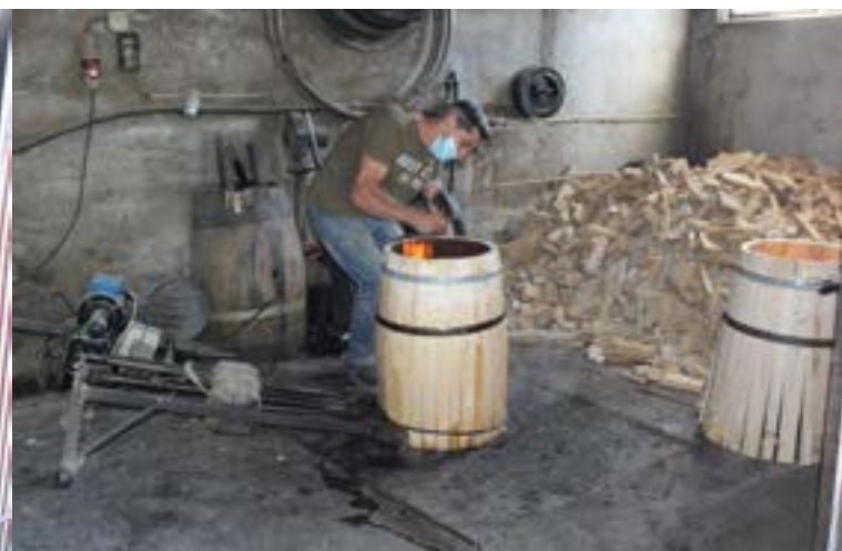
Fig. 15 Colocação dos arcos provisórios no fogacho
