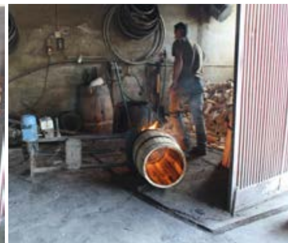
Fig. 16 Colocação do molde na base após o fogacho
