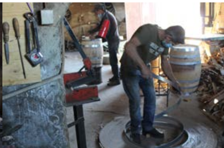
Fig. 19 Cortar os arcos
