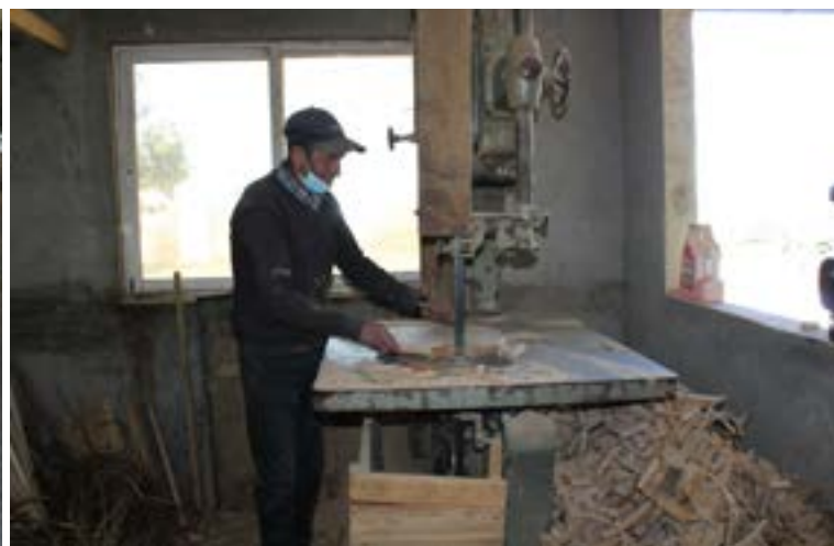
Fig. 26 Cortar os fundos na serra de fita
