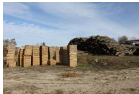
Fig. 3 Estaleiro da Tanoaria Borges onde são visíveis os troncos de castanho e as grades de castanho em processo de secagem
