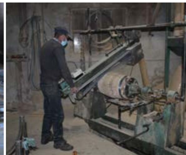
Fig. 28 Dar o acabamento, raspar o barril com uma lixadeira mecânica
