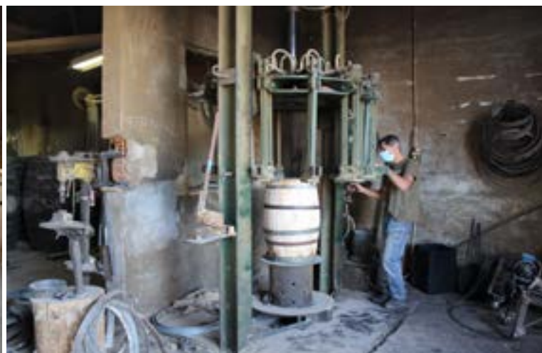
Fig. 18 Apertar os arcos provisórios na prensa mecânica
