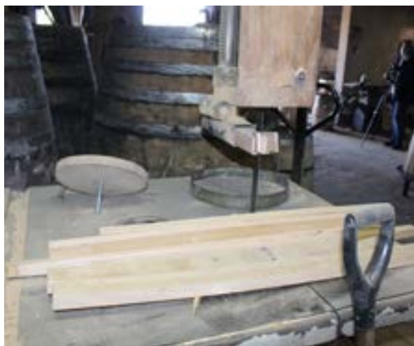
Fig. 5 Serra de Fita, utilizada para dar a talha à aduela
