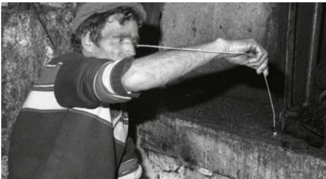
Fig. 12 Utilização de uma palha com uma azeitona na ponta para determinar a altura a que se encontrava o azeite
