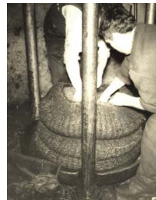
Fig. 7 Enseiramento no lagar de azeite de Fontelonga
