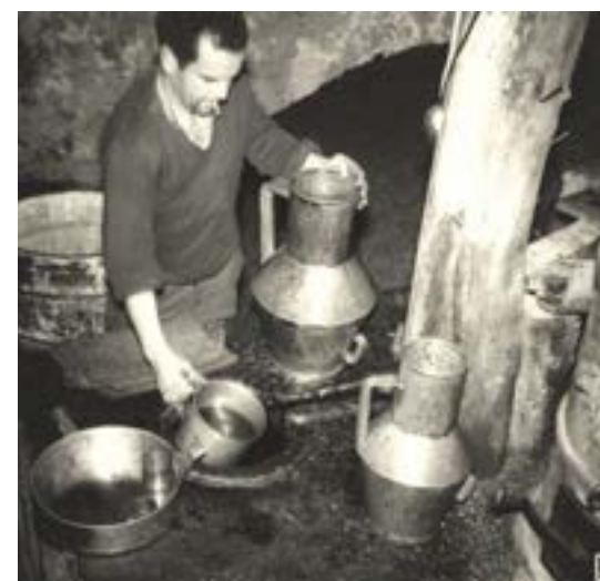
Fig. 10 e 11 Retirada do azeite do tesouro para as medidas de capacidade líquida, como canada e cântaro
